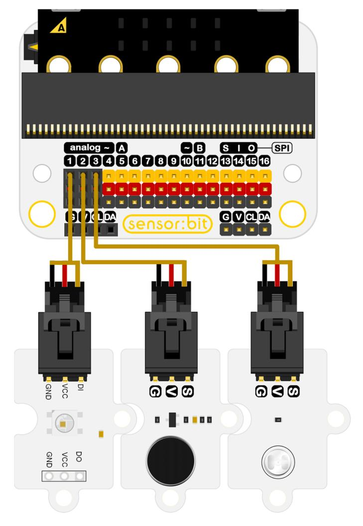
Connectez une LED arc-en-ciel à P1 du bit sensor.
