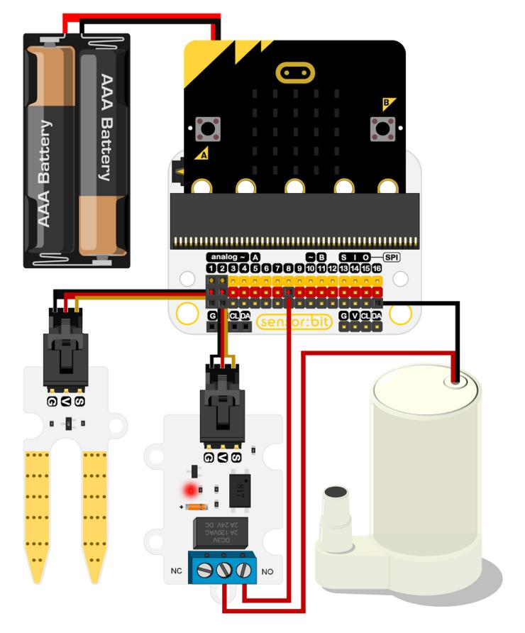
Lors de la connexion des câbles au relais, veuillez d'abord utiliser des tournevis pour desserrer les vis du relais afin de vous assurer que les câbles sont correctement connectés.
